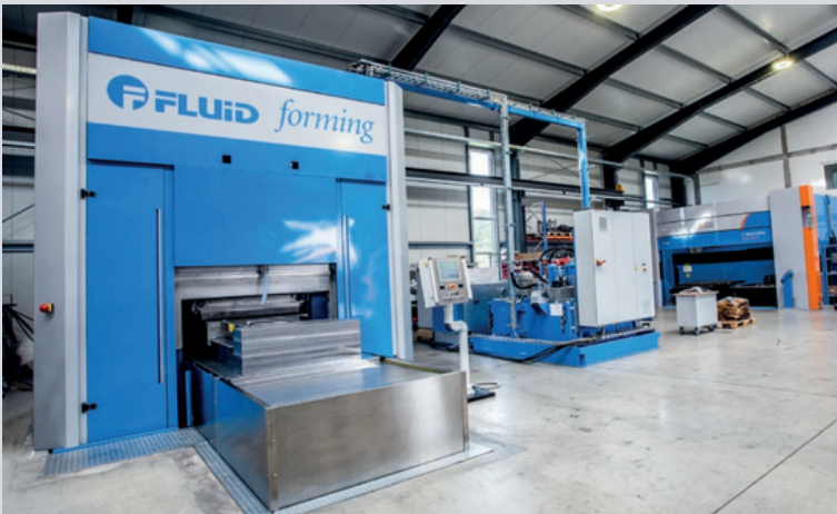
Der FormBalancer ist eine Hydroformmaschine mit der mit hohem Wirkdruck metallische Platinen in eine Werkzeugform geformt werden.
