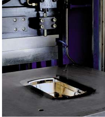
Bild 2: Der geringe Werkzeugkostenaufwand entsteht im Wesentlichen dadurch, dass nur noch eine Werkzeughälfte, nämlich die Negativform, die als Kavität ausgebildet ist, benötigt wird.
